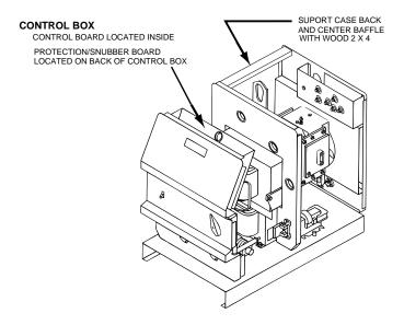
FIGURE F.7 - LOCATION OF PROTECTION/SNUBBER BOARD.
